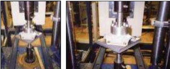
**2<sup>ème</sup> TEST :** Application d'une tension le long d'un axe incliné par rapport à l'axe de symétrie de la pièce.
