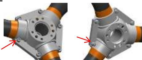
Depuis l'avant du moyeu, mettre en place les 6 vis courtes M8x25mm d'assemblage du moyeu.
