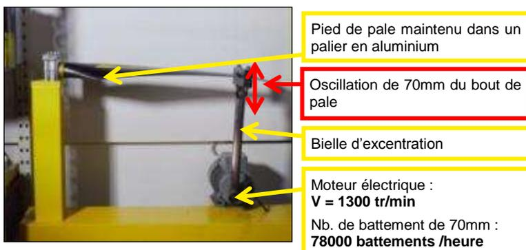
Les pales DUC ont subi un test de flexion pendant 30 heures soit 2 340 000 cycles d'oscillation de 70mm.
