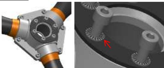
Positionner la rondelle de serrage sur la face avant du moyeu de l'hélice (côté autocollant), puis placer les 6 grandes vis de fixation M8x100/110/120mm avec leur rondelle.
