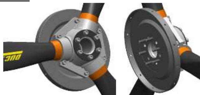
Depuis l'arrière de l'ensemble, positionner la platine de fixation du cône selon les vis de fixation.
