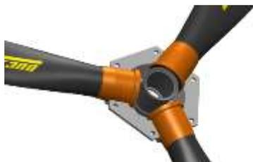
Placer les pales dans leur logement en les calant vers l'extérieur. **Orienter l'autocollant DUC face à vous.**
