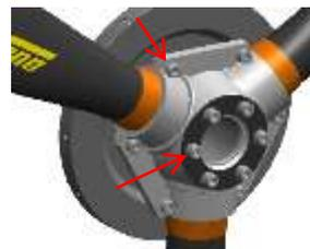
Desserrer légèrement les vis d'assemblage de manière à ce que chaque pale puisse pivoter dans son logement.
