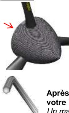
Une fois que tous les réglages de l'hélice ont été réalisés, monter le cône de l'hélice en serrant les vis à un **couple 4Nm (0.4kg/m)** avec l'outillage approprié.
