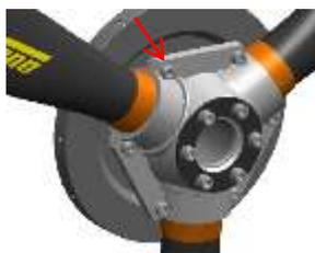
Lorsque les pales sont réglées à l'angle approprié de leur application, serrer l'ensemble des vis à un **couple de 25Nm (2.5kg/m)**.
