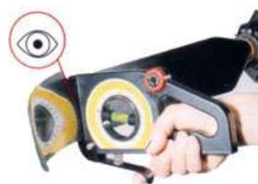
Régler l'angle de calage des pales avec l'outil de réglage. Consulter la rubrique **4.4. Réglage de l'angle de calage de l'hélice.**
