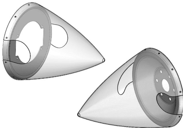
Ces nouvelles platines de cône d'avions TB sont entièrement réalisées en matériaux composites (fibre de carbone exclusivement).
