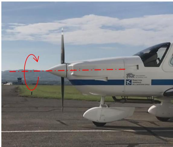
L'essai de rotation en statique doit être réalisé sur l'ensemble de la plage de rotation du moteur. Dans un premier temps, faites une évaluation lors de la rotation au ralenti moteur.
